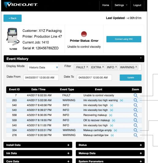
此仪表板屏幕显示系统从发出简单的警告消息到喷码机系统故障这 12 小时的历程。在该案例中,警告消息已发送,但并未得到处理。未及时处理此类故障导致了生产线停机两小时,以进行故障排除和更换故障的喷码机。如果已根据 Videojet Connect Remote Service 提供的通知快速采取措施,则可避免此类成本高昂的生产中断。
